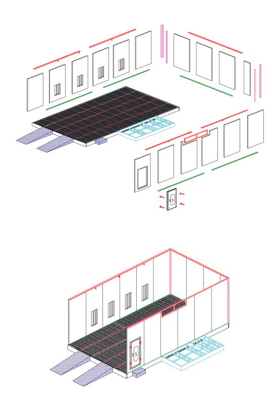
3) Проверьте диагональные размеры всех частей после окончательной установки, убедитесь в том, что разность в величинах диагоналей не превышает 5 мм, одновременно, используя отвес, проверьте вертикальность стенок кабины камеры.
