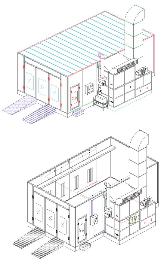
Для безопасной работы оборудования, после сборки всех частей, необходимо герметизировать все места, где возможны утечки воздуха, при помощи специального герметика. В противном случае в пространство кабины будет попадать пыль и негативно отражаться на качестве окраски.
