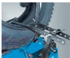
Настройка устройства расширения
