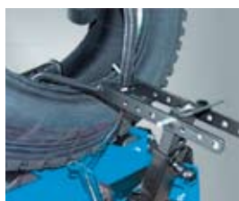
Настройка устройства расширения
