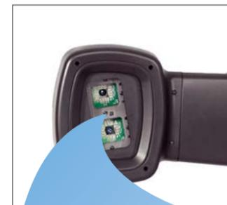
**Четыре цифровые камеры (по одной на каждое колесо) измеряют положение и ориентацию колёсных мишеней.**
