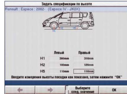
Измерения высоты посадки, требуемые производителями автомобилей, могут быть выполнены и введены вручную или с помощью опционного измерителя высоты (20-1885-1).
