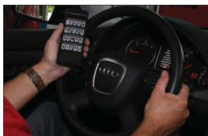
При помощи ИК ДУ (опция) можно управлять модулями линии прямо из тестируемого автомобиля. При этом можно провести отдельные этапы диагностики (например, испытание на тормозном стенде) по Вашему выбору или изменить их последовательность.
