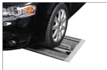
При помощи поднятия и опускания встроенной балки с пневмоприводом автомобиль въезжает на стенд, после чего ось автомобиля плавно опускается на тормозные ролики. При выезде балка поднимает ось, что позволяет не запускать стенд повторно. Это исключает опасность повреждения бампера и днища автомобилей с малым дорожным просветом или колесами малого диаметра.
