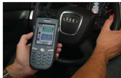
PWA (опция) – pocket workshop assistant – это карманный компьютер с установленным русифицированным программным обеспечением CARTEC, одновременно выполняющий функцию ПДУ. Он может заменить другие средства индикации (аналоговый дисплей и монитор). Испытаниями можно управлять из автомобиля, при этом на встроенном дисплее отображаются управляющие кнопки для текущего этапа испытания. Управление осуществляется посредством сенсорного экрана. Для работы PWA необходимо наличие РС.
