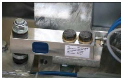
Измеряемые параметры обрабатываются при помощи тензометрических датчиков. Надежная неизнашиваемая измерительная электроника безошибочно фиксирует возникающие силы.
