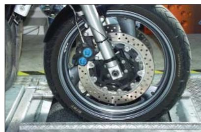
Тормозной стенд может быть дооснащен для испытания мотоциклов.
