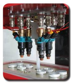
На стенде может быть протестировано от 2-х до 8-ми форсунок одновременно.
