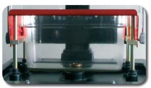
Камера визуального контроля изготовлена из поликарбоната. Этим обеспечивается высокая стойкость к механическим и химическим воздействиям.
